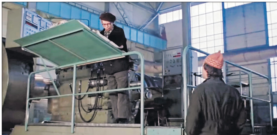
Игорь Брагин пытается занять денег до полочки. Сегодня этот мощный станок по-прежнему в строю, на нем обрабатывают валы роторов паровых турбин
