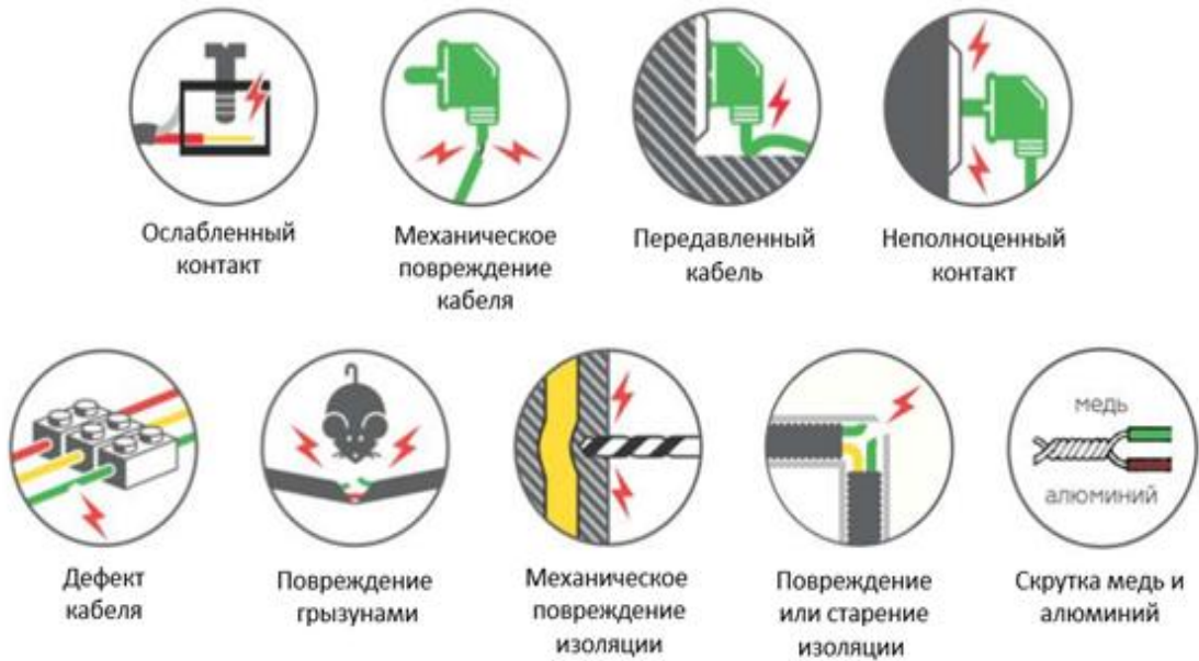
Рисунок 6. Возможные причины искрения в электропроводке
